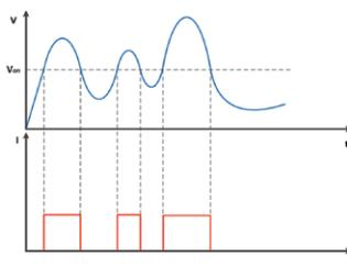
▲ 非锁定方式：输入电压高于V<sub>on</sub>则带载，输入电压低于V<sub>on</sub>则停止带载
