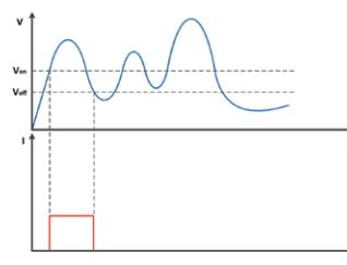
▲ 锁定方式：输入电压高于V<sub>on</sub>开始带载，输入电压低于V<sub>off</sub>时负载卸载。卸载后，输入电压再次高于V<sub>on</sub>，负载也不会自动带载。
